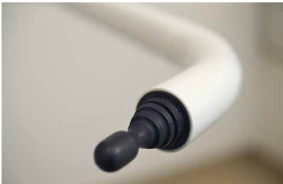
Betjeningsstik til Cura C14-modellen. Den er placeret på enden af toilettets ene armlæn, og borgeren kan derfor let komme til at aktivere den ved et uheld, især når borgeren sætter sig eller rejser sig fra toilettet. Se evt. forrige billede af Cura C14.
