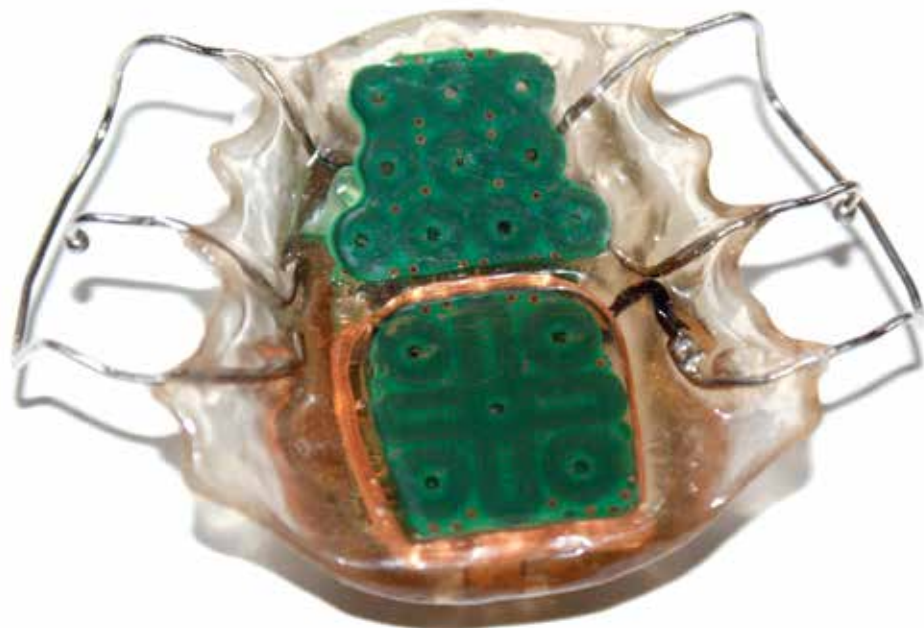
Ganebøjlen i Exotic-systemet har 18 induktive sensorer, som kan aktiveres med en tungepiercing eller en pålimet aktiveringsenhed.
