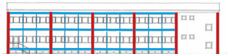
1980 Markering af hovedrammer samt underinddeling af fag med markering af etagedæk og sekundære søjler. 1:300.
