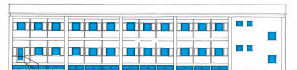
1980 Markering af hvor der er vinduer i facaden. Arealet er reduceret pga. blændpartierne omkring de kvadratiske vinduer. 1:300.
