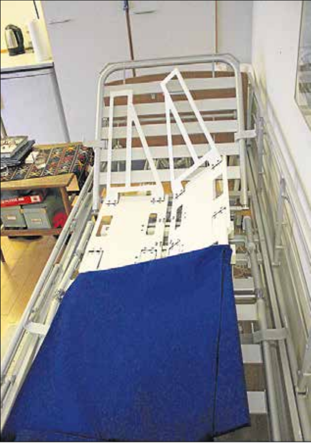
Sådan ser oversengen ud uden madras: Hovedgædet og siderne kan løftes, så borgeren kan vendes i løbet af natten og så borgeren nemmere selv kan stige ud af sengen.
