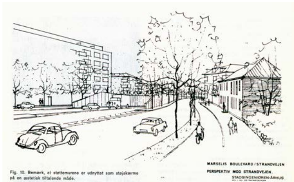
Fig. 10. Bemærk, at støttemurene er udnyttet som støjskærme på en arkitektonisk tilladende måde. Skitse af projektet for en tunnel under Strandvejen, 1974. Foto: Aarhus Kommunes beretning 1974-75.
