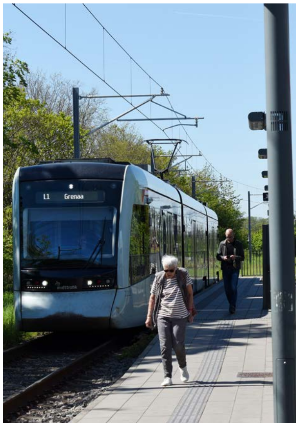
Indstigning i niveau til letbanetog på Lystrup Station, 2024.
