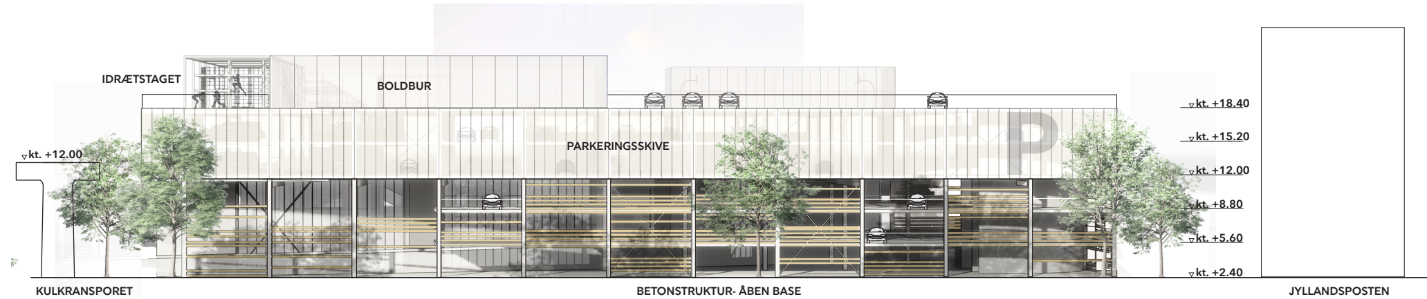
OPSTALT MOD ØST 1:500 EN LYSNDE SKIVE MOD HAVNEN Parkeringshuset består af en åben base og en afskærmet skive, der spænder henover havnesporet. Skiven beklædes med materialer, der lyser op i mørket
