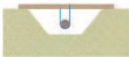
Figur 2: Eksempel på ophæng af plastisolerede kabel i udgravning. Som udgangspunkt er plastisolerede kabel rød, men tidligere årgange kan have en anden farve.
